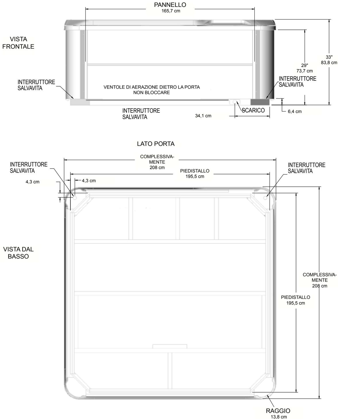
**NOTA:** WATKINS WELLNESS consiglia di installare il modello PROPEL su una base di cemento armato spessa 10 cm o una struttura solida in grado di sostenere il peso morto indicato nella tabella delle specifiche della vasca idromassaggio.
